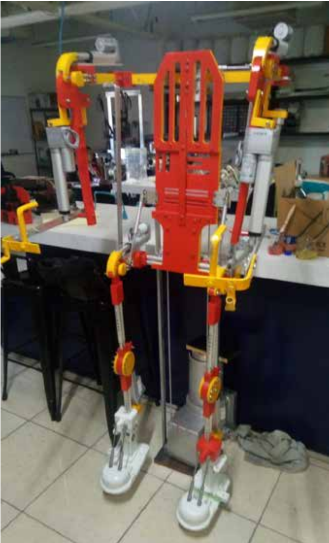
Figura. 1. Exoesqueleto de aumento de fuerza, desarrollado para aplicaciones industriales. CINVESTAV, CDMX.
