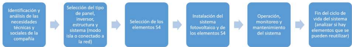
Figura 2. Marco conceptual S4 resumido para instalar, operar y disponer de un sistema solar FV
